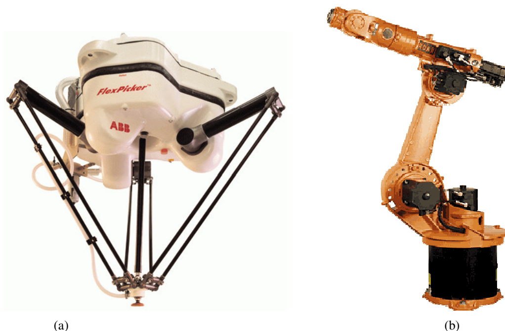
Figura 3– Mecanismos: (a) paralelo; (b) serial.
